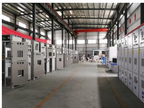
图 1-3 高低压成套电气装置生产中心
